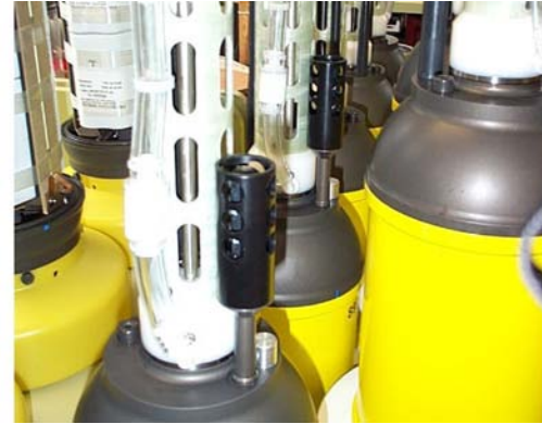
Imatge del CTD (Conductivitat-Temperatura-Profunditat) instal·lat a la boia
