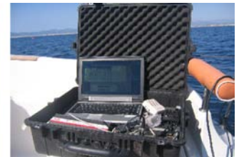
Detall de la part submergida (hidròfon direccional, caixa d'electrònica i brúixola) i la maleta de control i recepció, que es compon de l'ordinador, el receptor GPS, el receptor de l'hidròfon i la inversora
