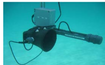
Detall de la part submergida (hidròfon direccional, caixa d'electrònica i brúixola) i la maleta de control i recepció, que es compon de l'ordinador, el receptor GPS, el receptor de l'hidròfon i la inversora
