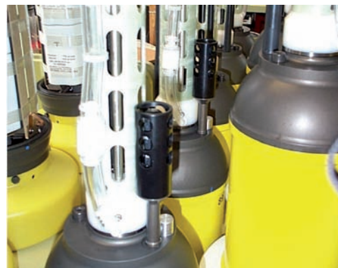
Detalle del CTD (Conductividad-Temperatura-Profundidad) instalado en la boya
