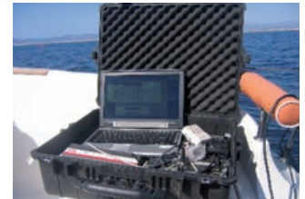
Detalle de la parte sumergida (hidrófono direccional, caja de electrónica y brújula) y maleta de control y recepción, compuesta por el ordenador, el receptor GPS, el receptor del hidrófono y la inversora
