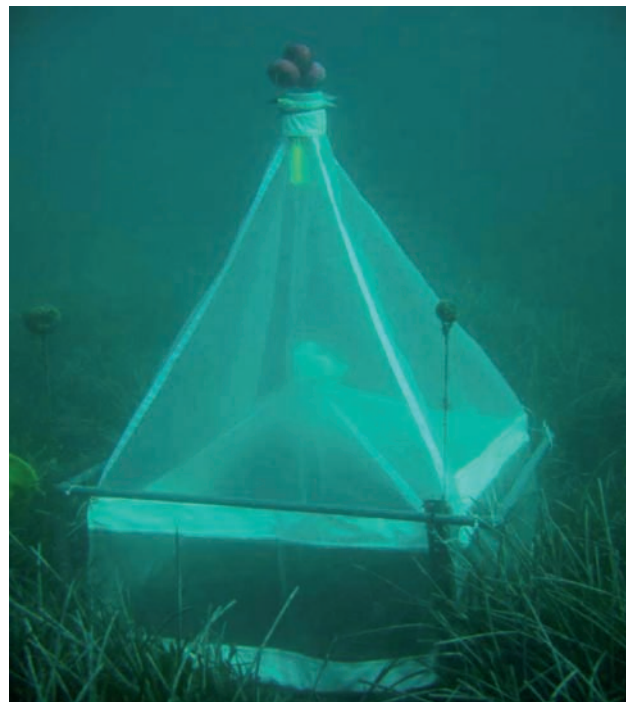
Dispositivo utilizado para el muestreo faunístico de infauna de fondos arenosos. La trampa se instala sobre el fondo a la puesta de sol y se recoge al amanecer, capturando de forma pasiva los organismos que se desplazan desde este a capas superficiales durante el ciclo nictameral
