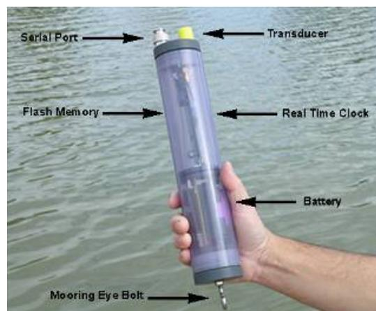
Componentes del receptor SUR-1 de Sonotronics.
