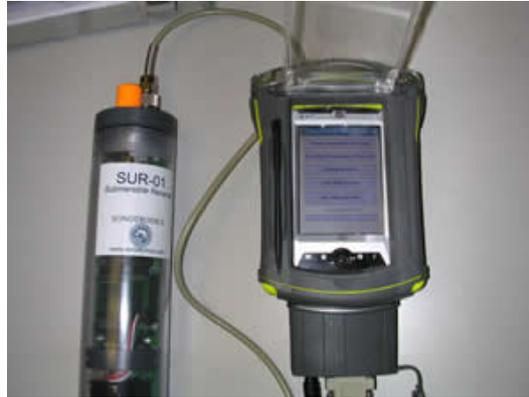
Sistema utilizado para la descarga de datos del receptor.
