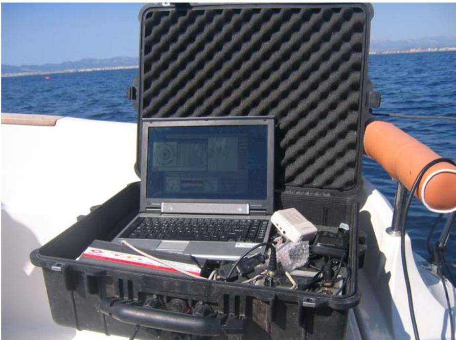
Maleta de control y recepción, compuesta por el ordenador, receptor GPS, receptor del hidrófobo e inversora. Todo el sistema se alimenta a través de la batería de la embarcación.
