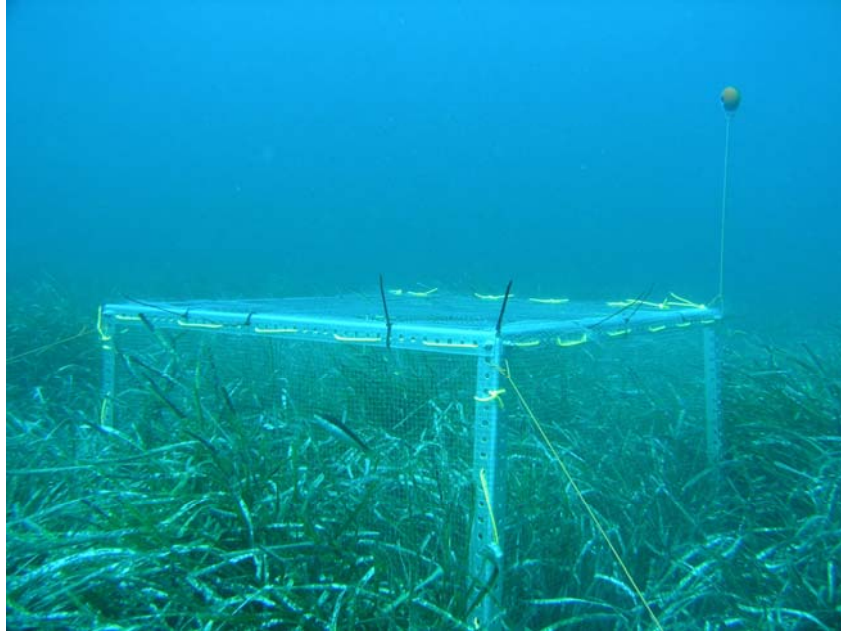
Figura 2a. Jaula diseñada para impedir el acceso de los peces a las parcelas experimentales
