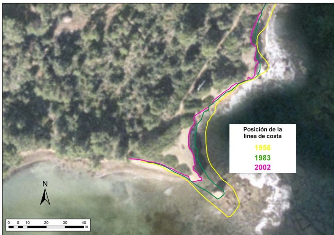
Figura 7: Es Faralló d'Alcanada (Alcúdia). Imagen escaneada y georeferenciada de 2002 (considerada como línea de costa actual). Posición de la línea de costa de acuerdo con las fotografías aéreas de 1956, 1983 y 2002.
